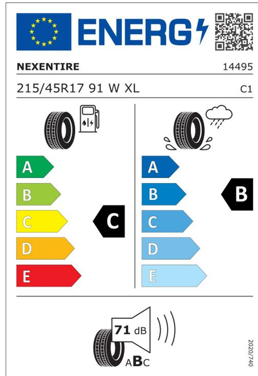
Im Sinne der Kennzeichnungspflicht von Reifen finden Sie hier Informationen zu allen Reifentypen, die werksseitig für das gewählte Rad zur Verfügung stehen. Ab Werk besteht keine Möglichkeit zur Auswahl eines spezifischen Reifentyps. Die Reifenkennzeichnungspflicht gilt für die Reifenklassen C1, C2 und C3. Reservenoträder sind hiervon ausgeschlossen.
